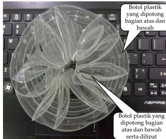
**Gambar 2. Sel Material AF yang Terbuat Dari 4 (empat) Botol Plastik Bekas Kemasan Air Minum dalam Botol 600 ml**
