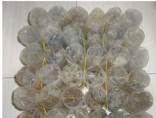
**Gambar 3. Sel-sel AF Dijahit Membentuk Unit AF Berukuran 2 m × 4 m**
