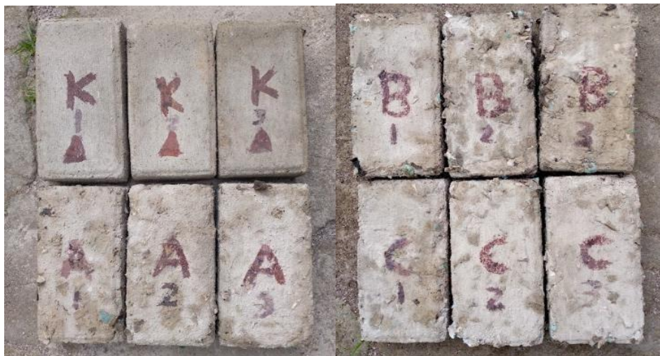
Gambar 1. Hasil pencetakan paving blok dengan campuran limbah masker (Sumber; dokumentasi penelitian 2022)
