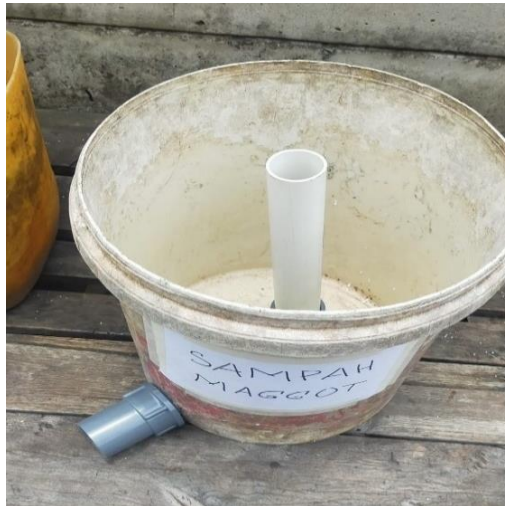
Gambar 2. Pemasangan Pipa PVC ke Reaktor Kompos
