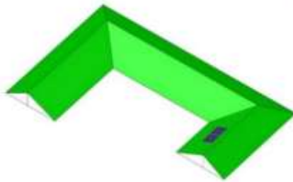
Gambar 2. Desain Penyusunan Rangkaian Panel Surya Risen Mono-crytalline 400 Wp di Atap SD N 1 Temuwuh
