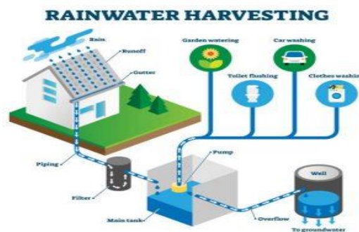
Gambar 1. Desain Sistem Pemanenan Air Hujan
